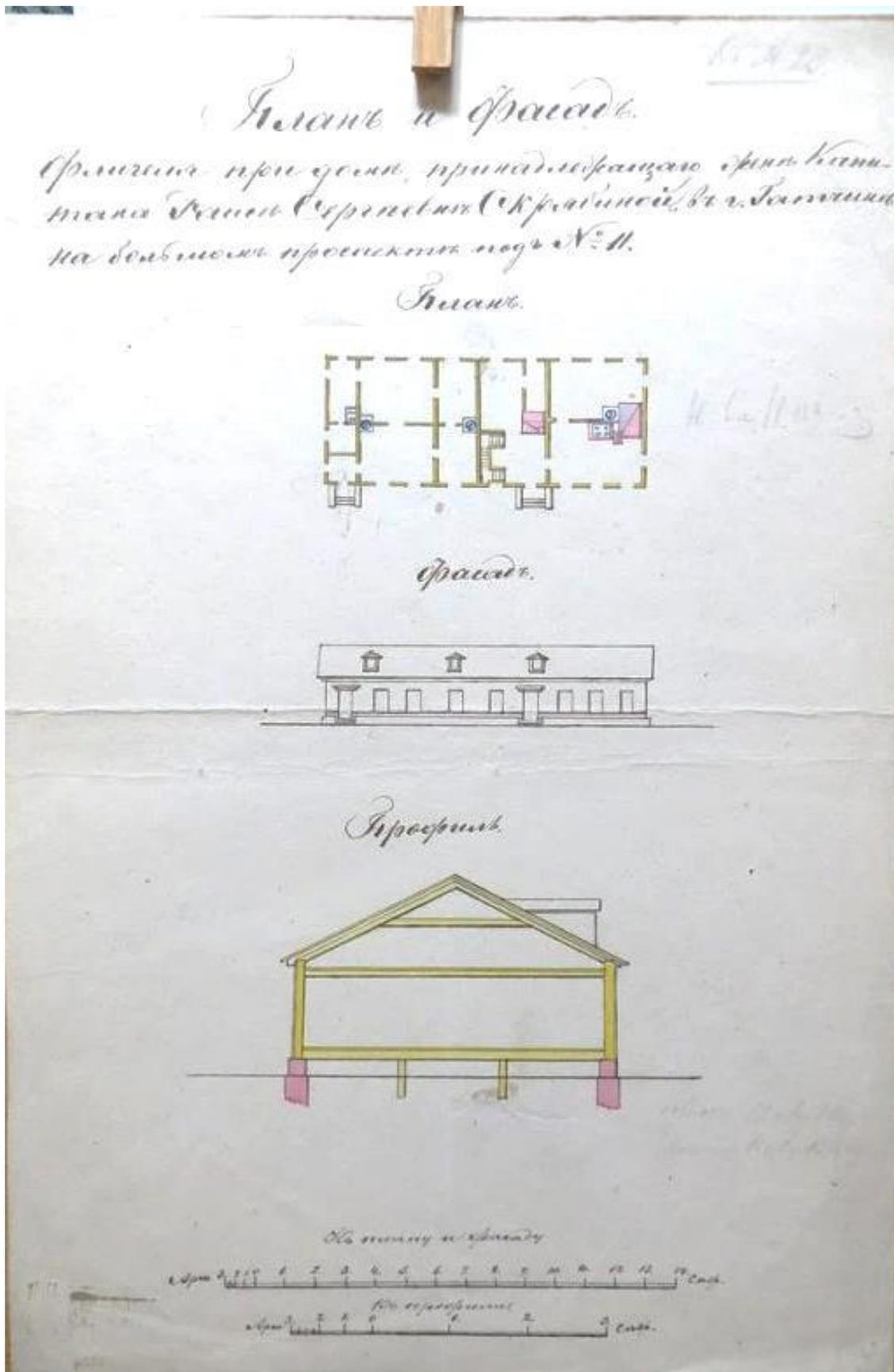
Рис. 2.51. Фасад, план, разрез флигеля при доме Скрябиной [в г. Гатчине на Большом проспекте под № 11], сер. XIX в. (предположительно 1850 г.) Автор неизвестен. // Государственный музей-заповедник "Гатчина" - ГМЗ «Гатчина». ГДМ-943-ХII (ГДМ КП-3148). Режим доступа: <https://goskatalog.ru/portal/#/collections?id=37210872>
