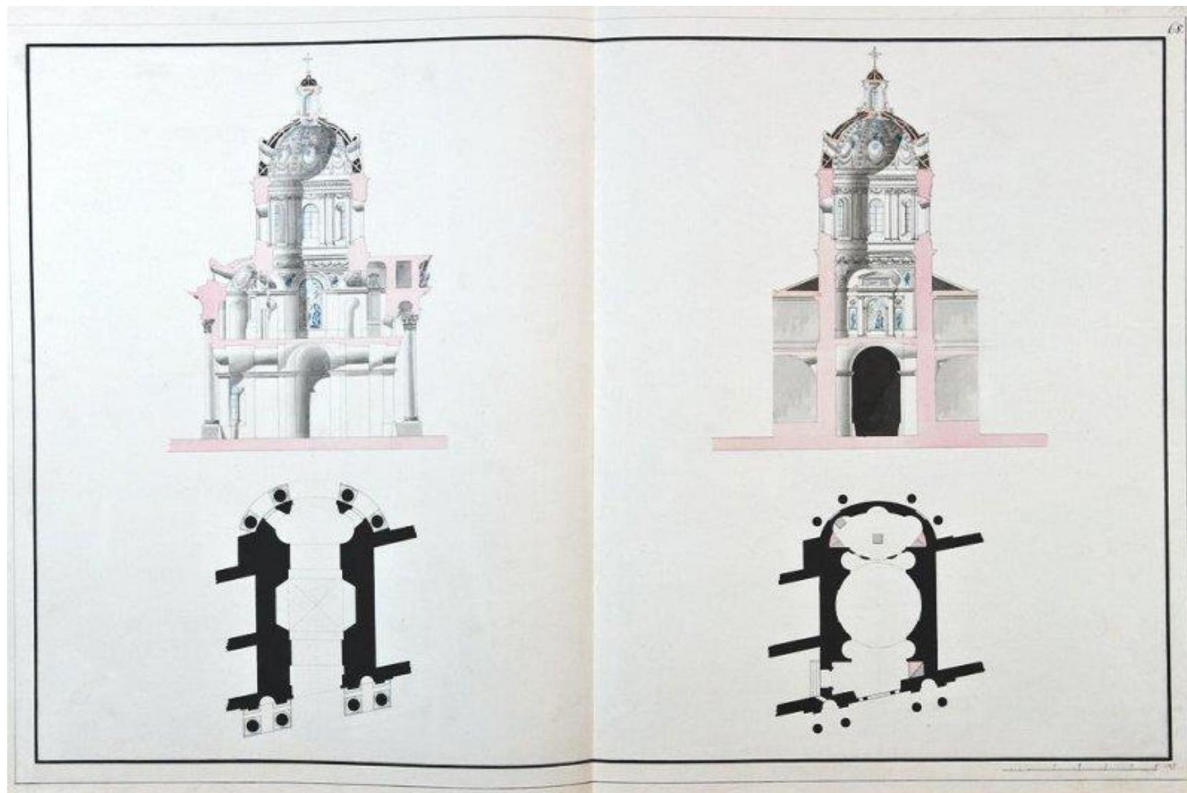
Рис. 2.20. План и разрезы церкви в Ингенбурге, из Атласа оберамтов Гатчины и Новосквиц, 1794-1798 гг. Автор неизвестен. // Государственный музей-заповедник "Гатчина" - ГМЗ «Гатчина». ГДМ-109-ХІ (ГДМ КП-2/59). Режим доступа: <https://goskatalog.ru/portal/#/collections?id=12810520>
