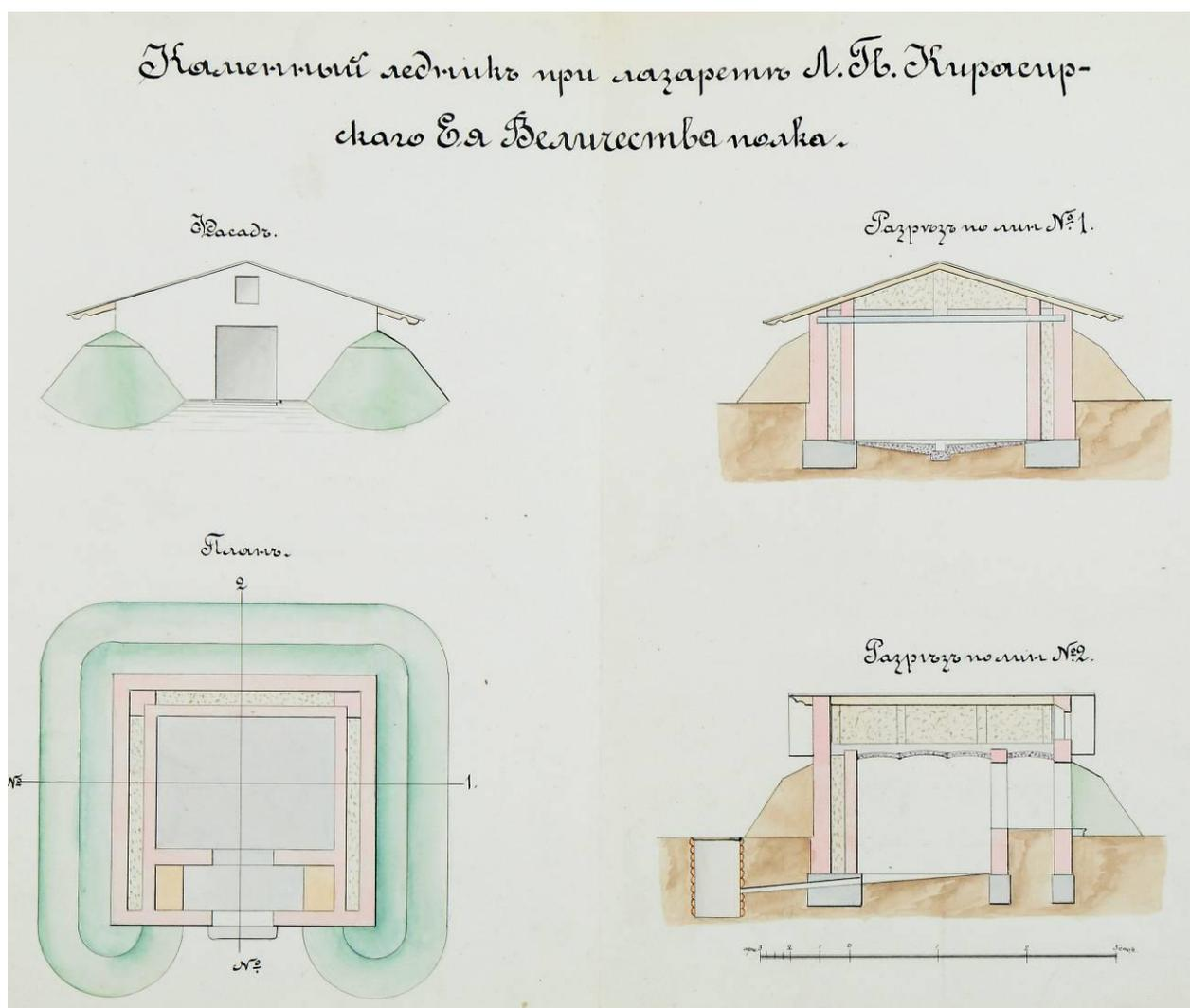
Рис. 2.68. Фасад, план, разрез ледника при лазарете кирасирского полка, из комплекта чертежей зданий Л.Гв. Кирасирского Ея Величества Государыни Императрицы Марии Федоровны полка в г. Гатчине, втор. пол. XIX в. Автор неизвестен. // Государственный музей-заповедник "Гатчина" - ГМЗ «Гатчина». ГДМ-805-ХП (ГДМ КП-3010). Режим доступа: <https://goskatalog.ru/portal/#/collections?id=15608932>.
